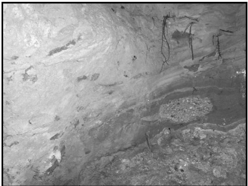
Fig 12 – Fotografia da colmatação de um desmonte mineiro subterrâneo, com fracção grosseira em baixo e fina por cima (separação hidrogravítica).
