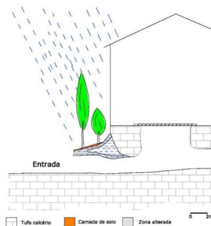
Figura 31 - Processos de alteração na zona de entrada de Grutas de Lapas. Extraído de FERNANDES, J. P. (2014).
