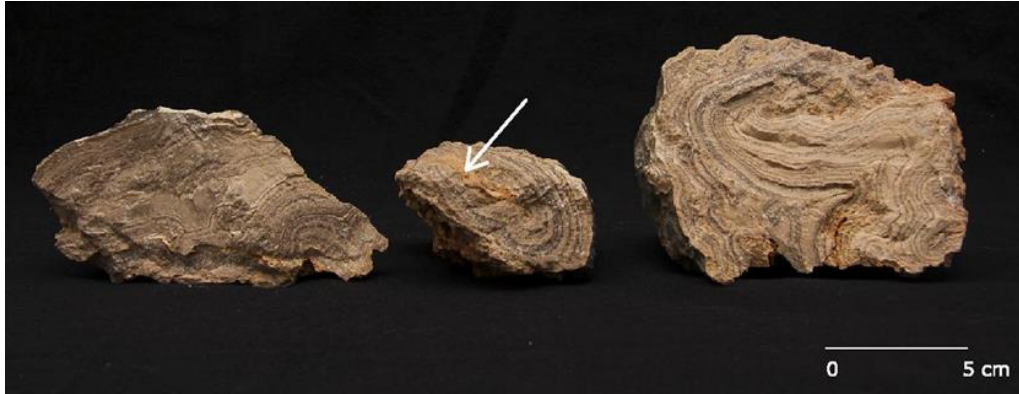
Figura 19 - Amostras de mão de travertino, no Vale Sobral, Casais Martanes. Na amostra ao centro observa-se um clasto de calcário (seta) em redor do qual se formaram as bandas de calcite.
